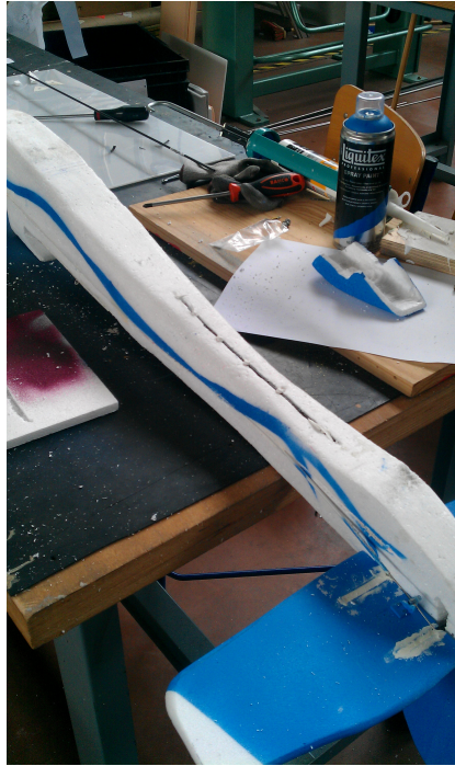
FIGURE 4.9 – Renfort de la partie arrière du fuselage
