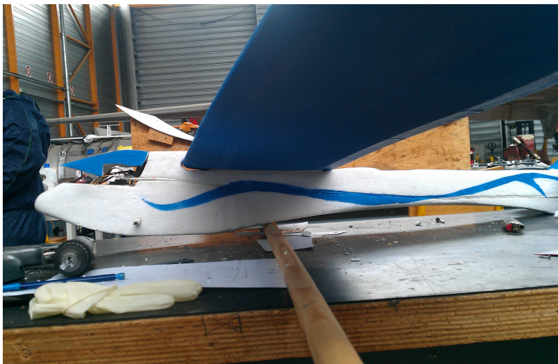
FIGURE 5.1 – Détermination du centre de gravité
