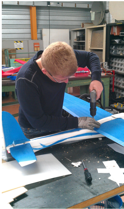
FIGURE 4.10 – Fixation de la voilure sur le fuselage
