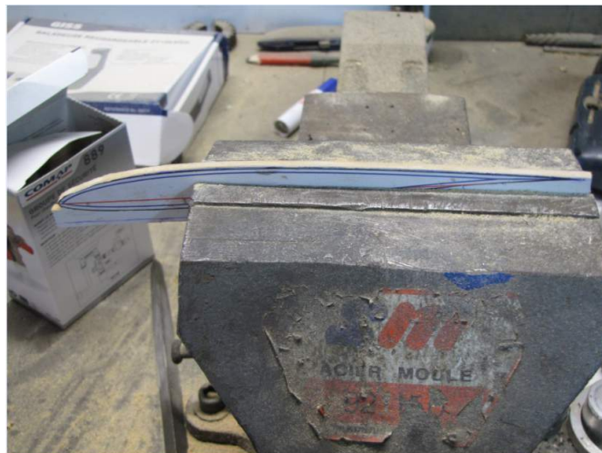
FIGURE 4.3 – Gabarit de guidage en cours de fabrication
