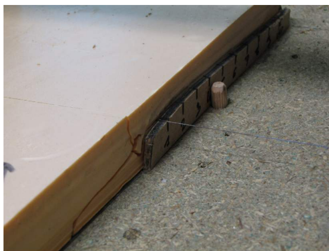
FIGURE 4.5 – Découpe avec les gabarits gradués
