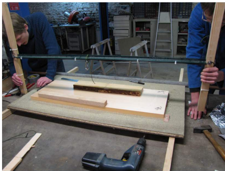
FIGURE 4.1 – Mise en oeuvre découpe au Fil Chaud
